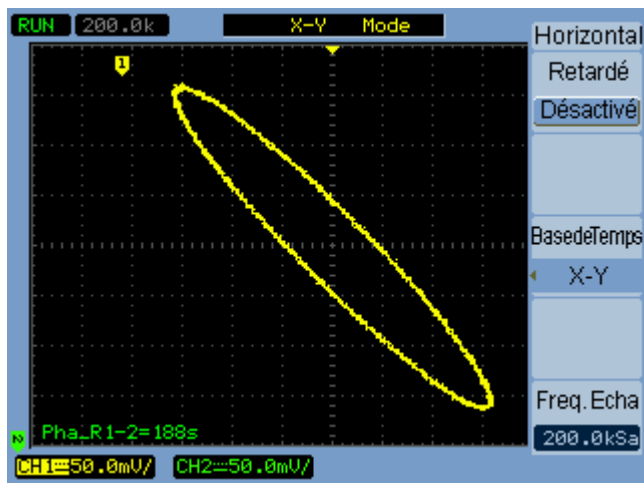
Figure 15 Format d'affichage X-Y présentant des signaux déphasés
